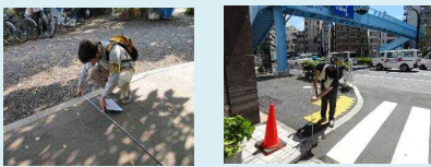
現地調査の様子 (左：幅員 右：段差)
