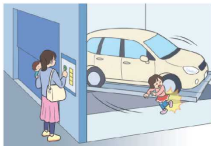
イラスト3 入庫後の安全確認不足による死亡事故例
