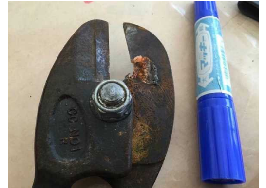
〔救援活動に際し、垂下った電力ケーブルを切断した時に融解したケーブルカッターの刃先: 熊本地震の例〕
