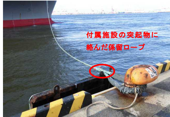
写真8：付属施設に絡んだ係留ロープ
