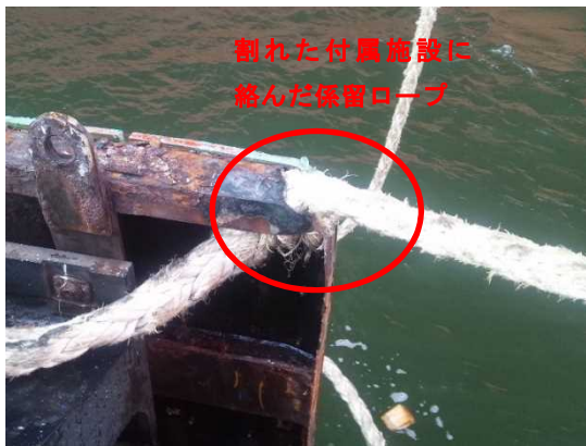
図11：係留ロープ切断事例
