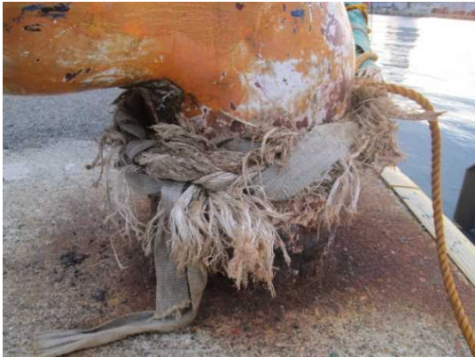
写真7：劣悪な係留ロープ
