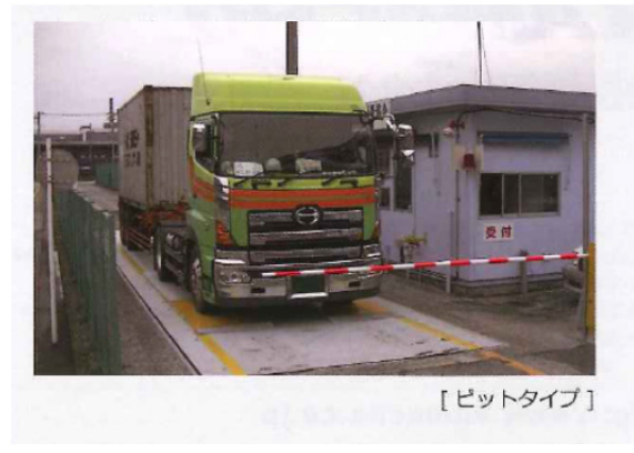
図 7-13 トラックスケールによる計量
