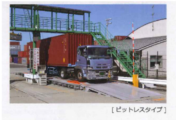
図 7-13 トラックスケールによる計量
