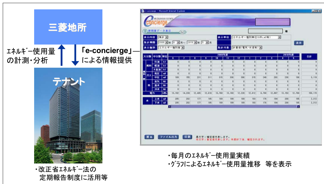
図 3-2 「e-concierge」におけるエネルギー情報提供システムの概要
