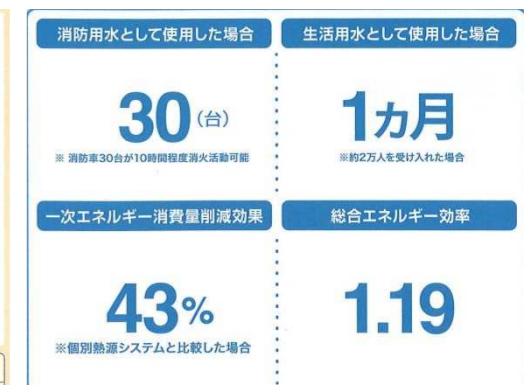
図一蓄熱槽水の活用による効果（晴海地区）
