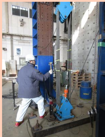
打診検査による振動数測定
