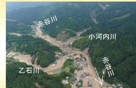
筑後川水系赤谷川における土砂・流木による埋塞状況
