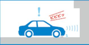
停止時や低速走行時に、車載レーダー等が前方や後方の壁や車両を検知している状態でアクセルを踏み込んだ場合には、エンジン出力を抑える等により、急加速を防止します。
