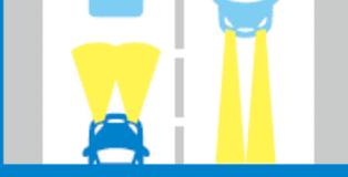
前方の先行車や対向車等を検知し、ハイビームとロービームを自動的に切り替える自動切替型前照灯、ハイビームの照射範囲のうち当該車両のエリアのみを部分的に減光する自動防眩型前照灯のほか、配光可変型前照灯があります。
