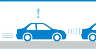
車載レーダー等により前方の車両や歩行者を検知し、衝突の可能性がある場合には、運転者に対して警報します。さらに衝突の可能性が高い場合には、自動でブレーキが作動します。
