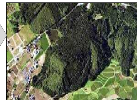
主要な基準点のみ現地測量し、上空からの写真や画像上で土地の境界点の座標値を一括算出
