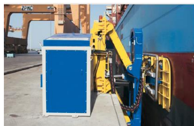
CAVOTEC社の自動係留装置(真空式)
