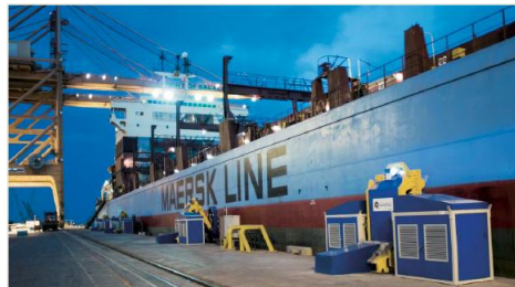
CAVOTEC社の自動係留装置(真空式)
