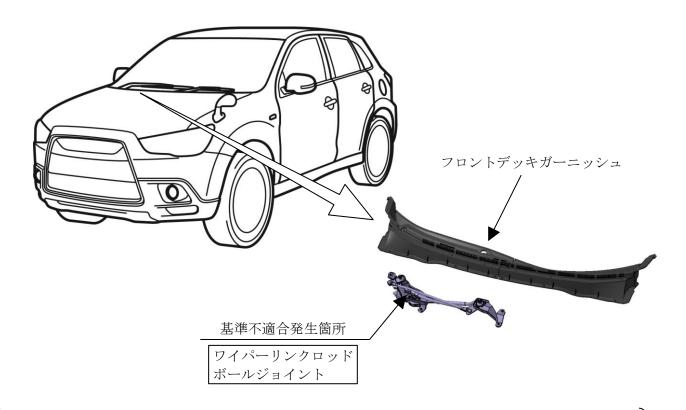
フロントワイパーにおいて、フロントデッキ部の防水構造が不適切なため、フロントデッキガーニッシュとウインドシールドガラスの間から伝った水がワイパーモーターとワイパーリンクのジョイント部に浸入することにより、ジョイント部内部に錆が発生し異常摩耗を起こすことがある。そのため、最悪の場合、ワイパーモーターとワイパーリンクのジョイント部が外れ、ワイパーが作動しなくなるおそれがある。
