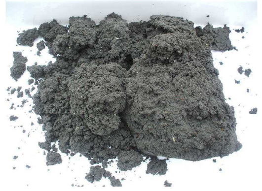
脱水汚泥（含水率約74%）
