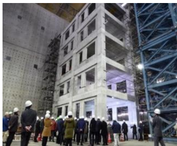
実大5層RC造建築物載荷試験
