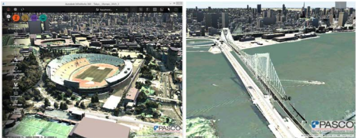
図 55 オブリークカメラ他を組み合わせた 3 次元鳥瞰図
