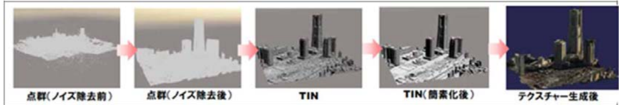
図 53 航空写真撮影による鳥瞰図作成プロセス
