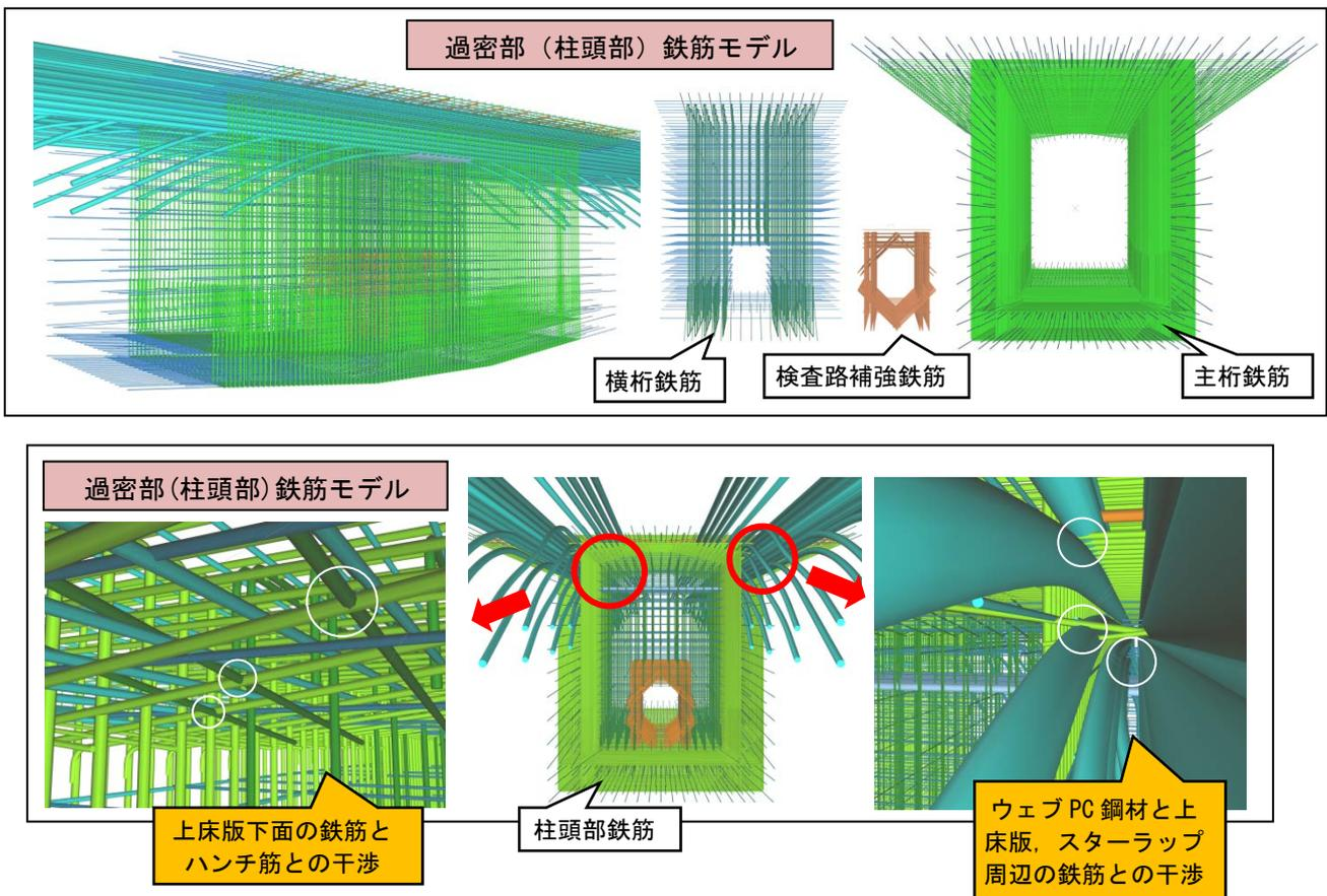
図 18 モデルイメージ (鉄筋)
