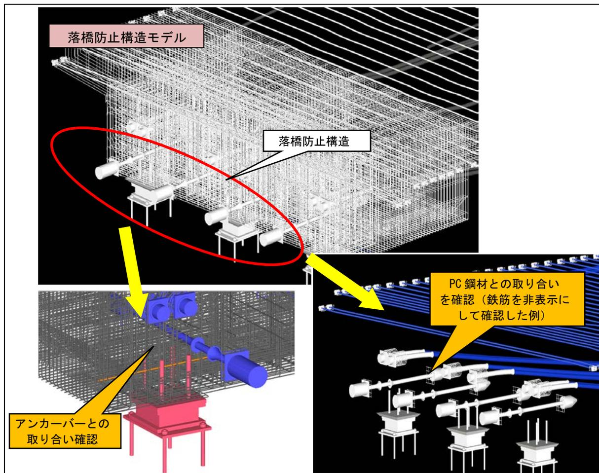
図 24 モデルイメージ (落橋防止構造)
