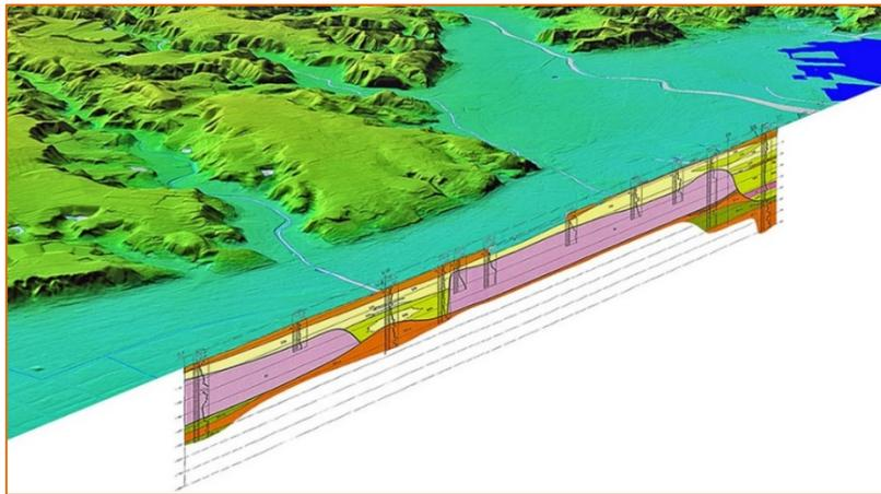
図 5 ルート選定時に準3次元断面図を利用する際のイメージ
