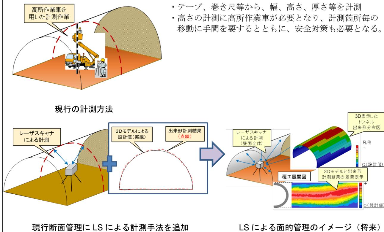
図 36 トンネルでの新たな手法による出来形管理
