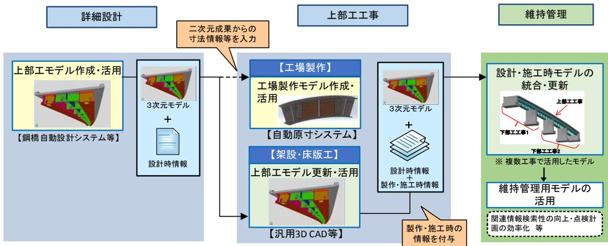
○当面のデータ連携実現イメージ：外部参照属性（設計情報）による詳細設計～工場製作間の連携
