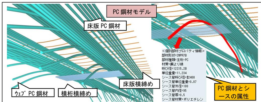
図 19 モデルイメージ (PC 鋼材、シース)
