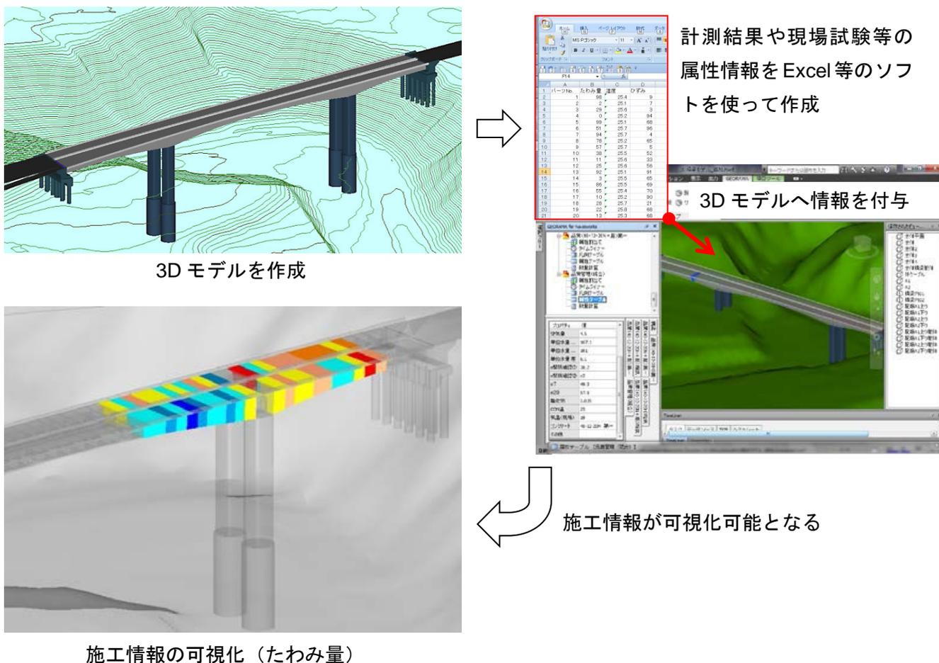
図 35 モデルへの施工情報付与事例
