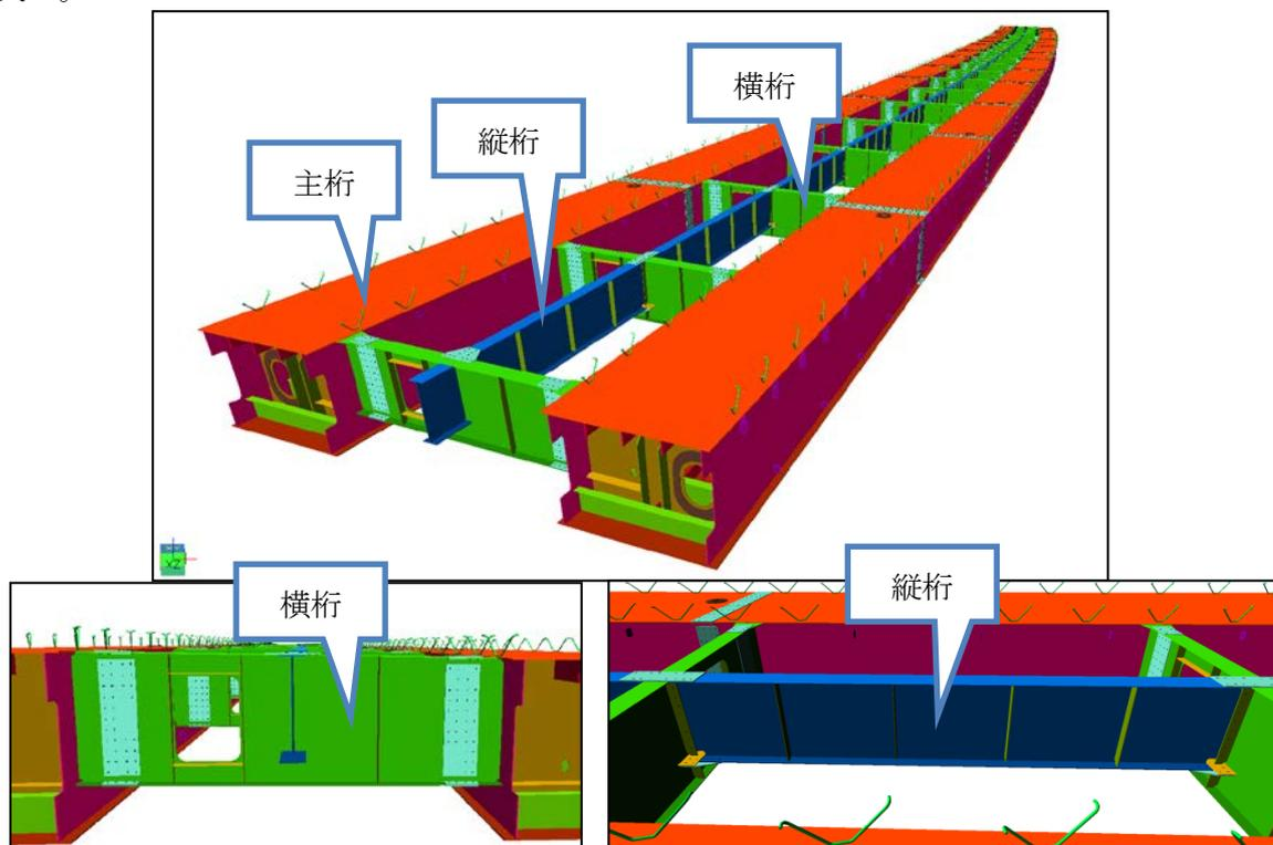
図 11 モデルイメージ（鋼箱桁）
