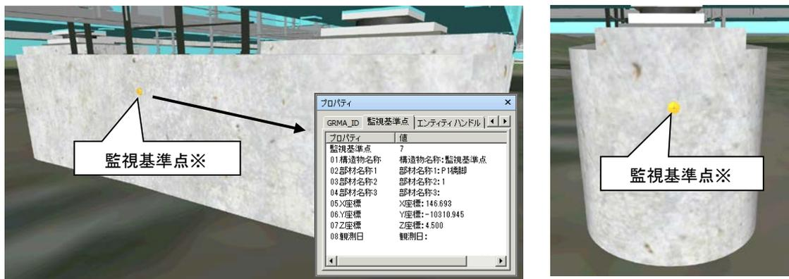
※下部工の橋脚の場合は「橋脚前面・後面」や「橋脚側面」が監視基準点となる
