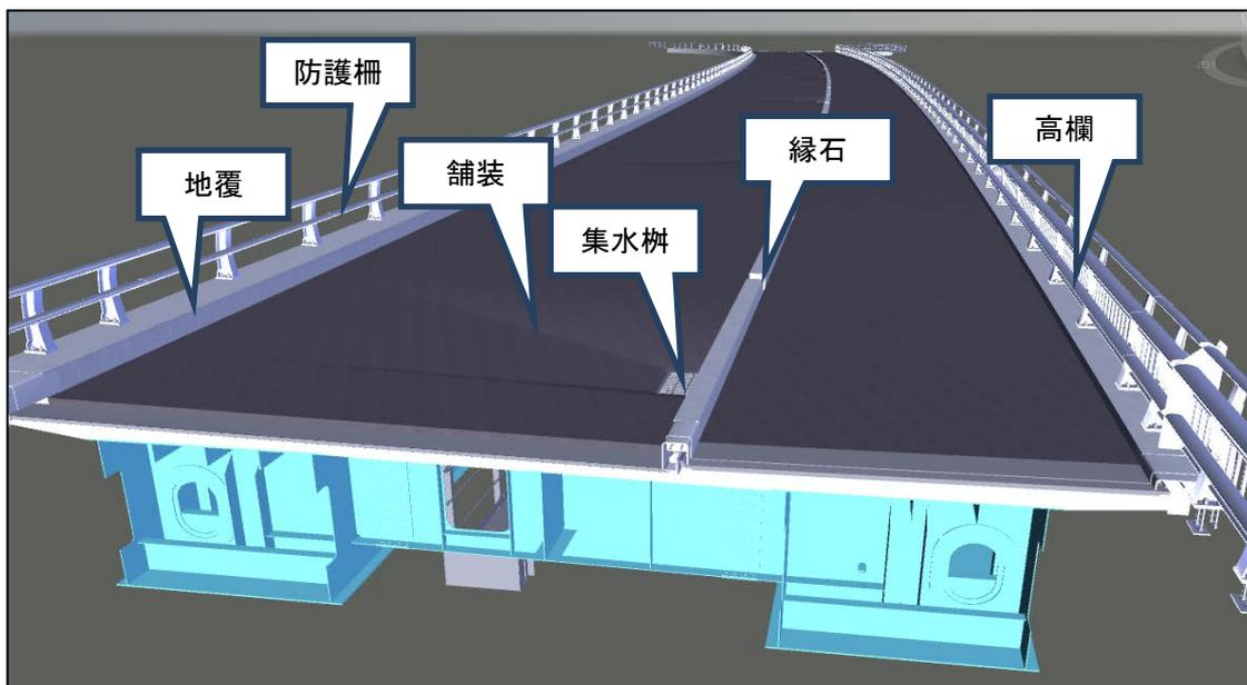
図 14 モデルイメージ（付帯構造物（路上））
