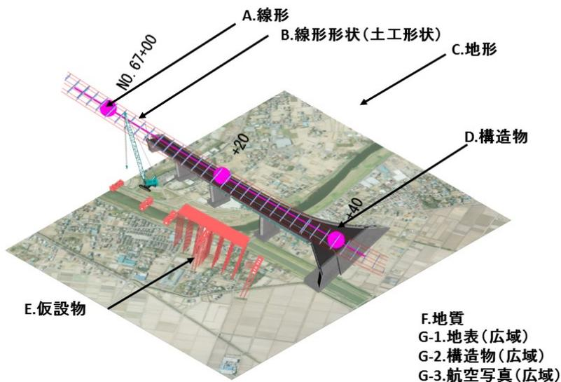
図 6 橋梁 CIM モデルの構造
