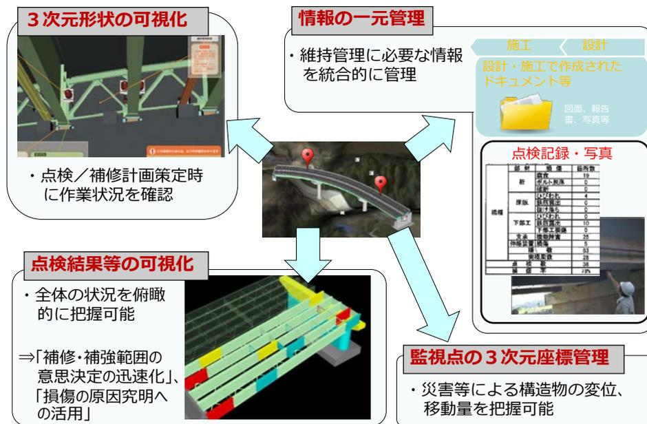
図 37 維持管理段階の橋梁 CIM モデルの例
