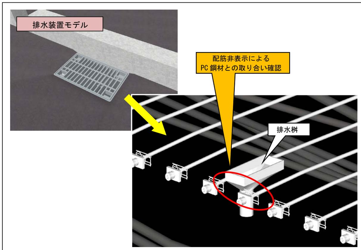
図 25 モデルイメージ（排水装置）
