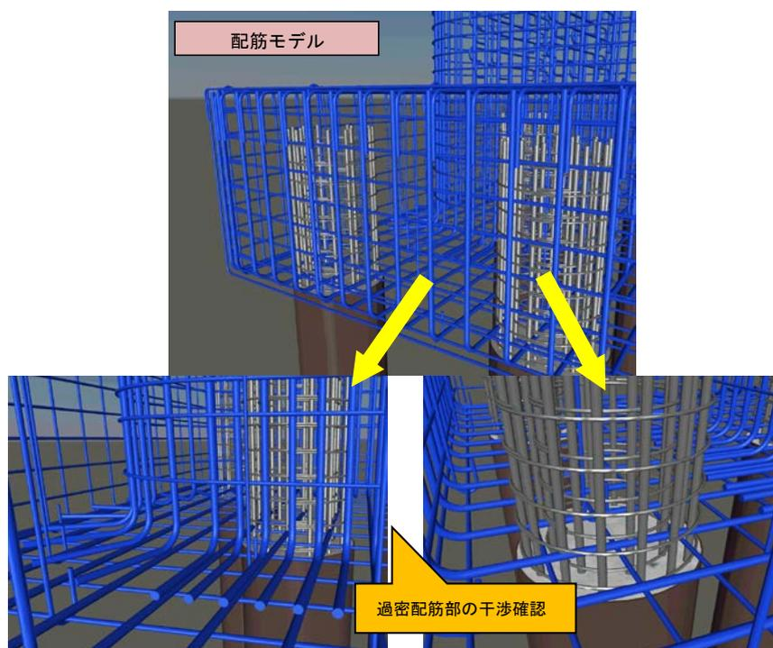
図 29 モデルイメージ（鉄筋：下部工）
