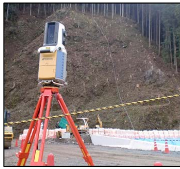
図 8 レーザースキャナーによる坑口周辺地形データ
