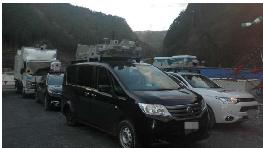
図 19 計測に使用した車載型レーザー 4 種
