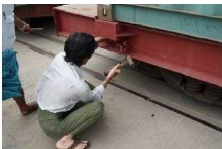
写真 14 ツイストロックが固渋している様子
