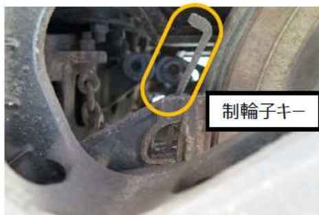
写真10 制輪子キー (固定金具)
