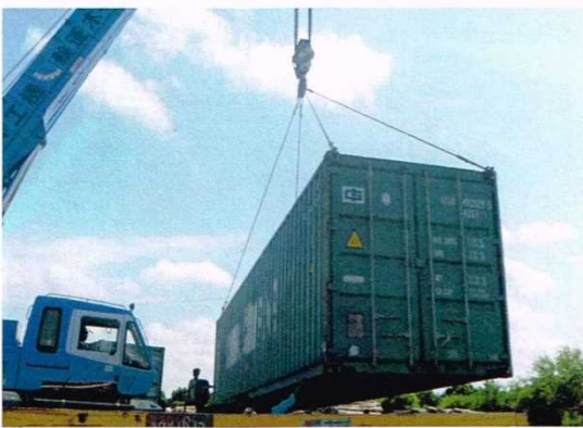
ラフタークレーンは固定のまま、 貨車が1コンテナ分づつ後退する。
