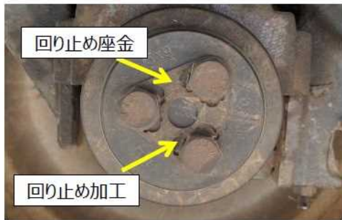
写真6 回り止め座金と回り止め加工
