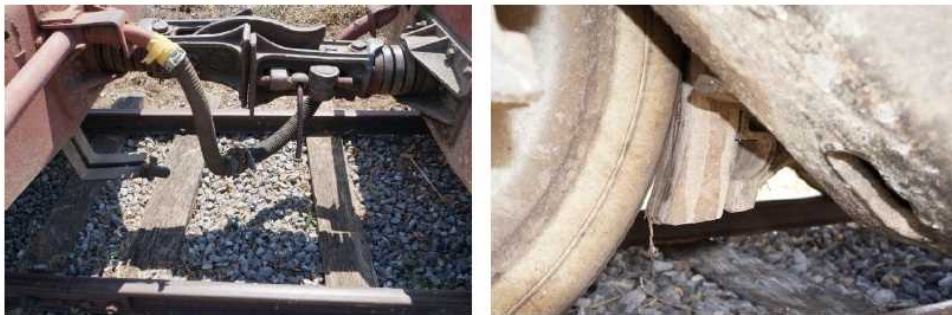
写真 16 左：かなり前よりブレーキホースを使っているように見える
