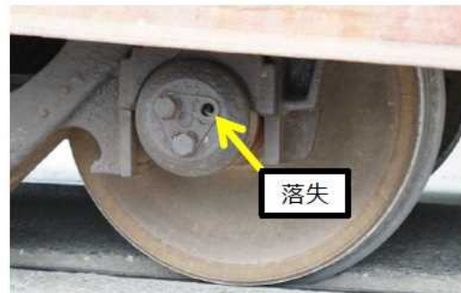
写真7 ボルト落失部
