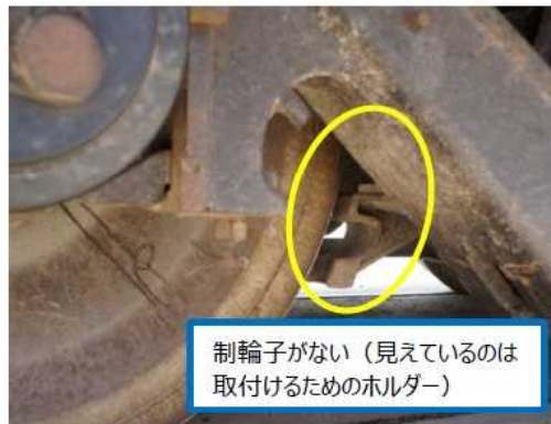
写真5 制輪子が取付いていない
