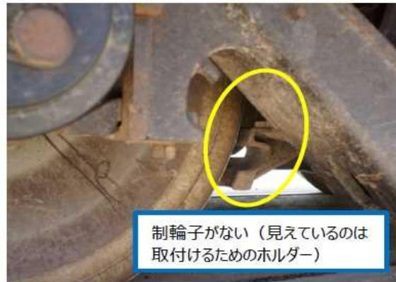
制輪子が取付いていない
