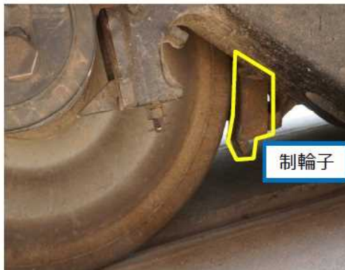
写真4 制輪子が取付いている状態（正常）
