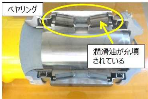
写真8 JR貨物の貨車の軸受けの構造 (カットモデル)
