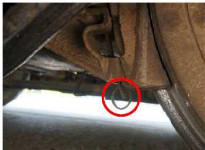
写真 12 キー脱落防止のリング施行例
