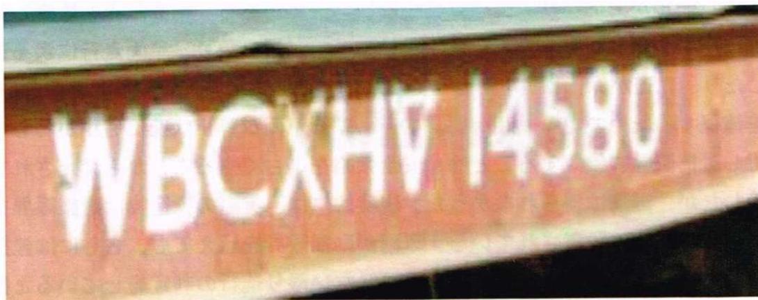
写真 2-2 ブレーキ不完全車両を表示する記号「▽」
