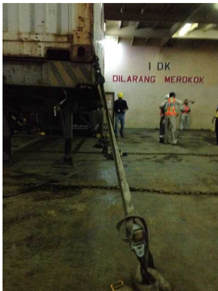
コンテナの固縛（縦から見た所）
