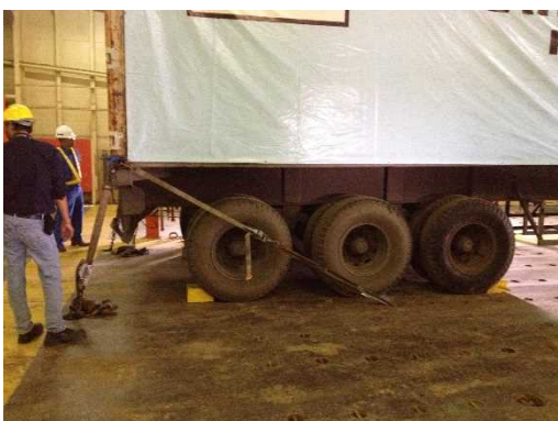
コンテナの固縛（横から見た所）
