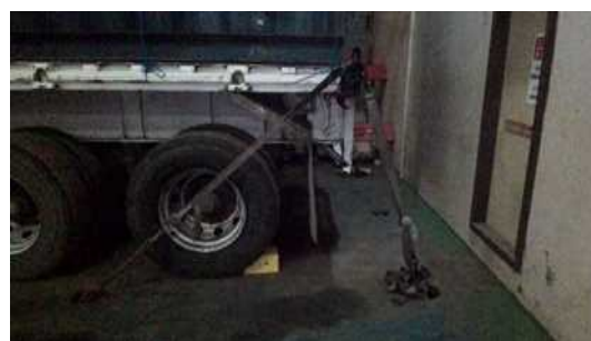
固縛に加えて輪留めを施す
