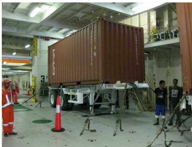
本船船腹内のコンテナ (トレーラ切離後)
