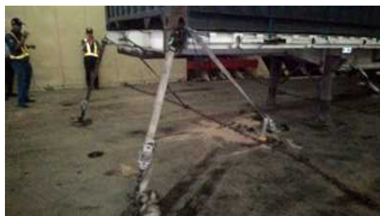
固縛の様子（床側）
