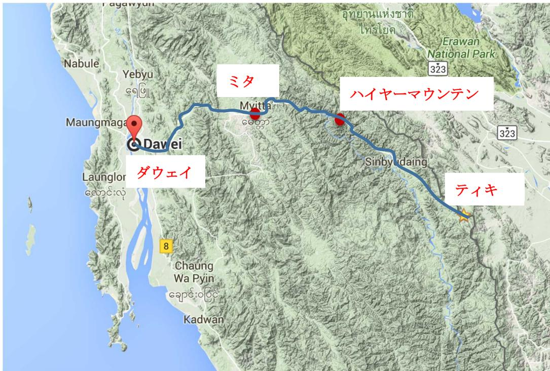
この区間は、ミャンマー側道路であり全区間未舗装道路である。ティキ～ミタ区間の数か所で傾斜が15度を超える急勾配のためコンテナ等の大型車輛の通行に支障がある。路面状況については、凸凹および砂利道で今回の実証実験ルートの中で本区間の路面状況が最も悪い区間である。ミタ～ダウエイ市街までは簡易舗装道路となり、路面状況は未舗装状態よりは良好となる。
