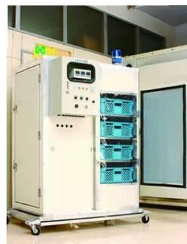
【蒸熱処理装置】
