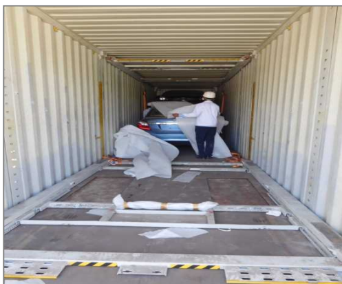
3 台目車両（前方下部）車両のラッシングベルトをはずす
