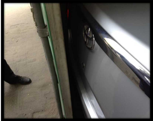
(コンテナとのクリアランスを確認 (10cm 確保))
