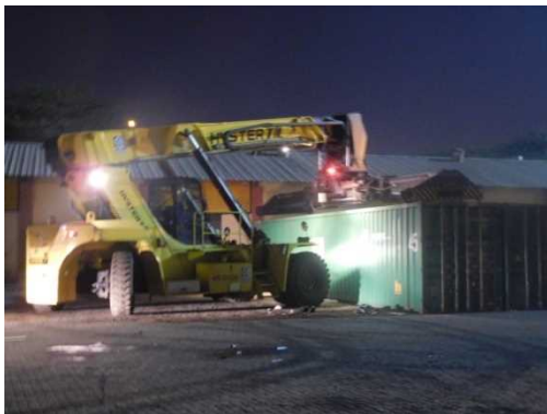
リーチスタッカーでバンニング済みのコンテナを持ち上げているところ
