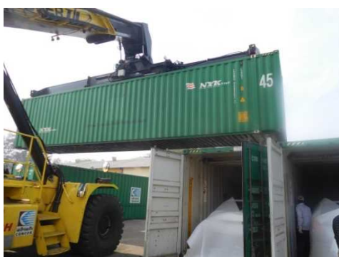
作業中のコンテナの頭上で実入り コンテナを旋回
