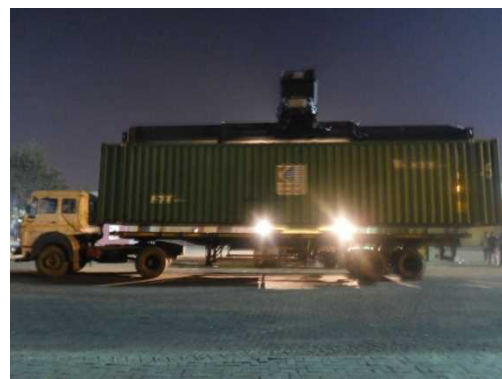
リーチスタッカーで横持ち用トレーラーにコンテナを搭載中
