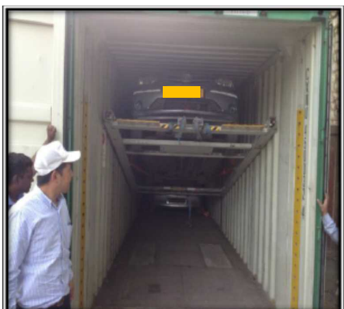
(3 台目を上部に昇降させ、フロントを上げ、下段スペースを確保)
