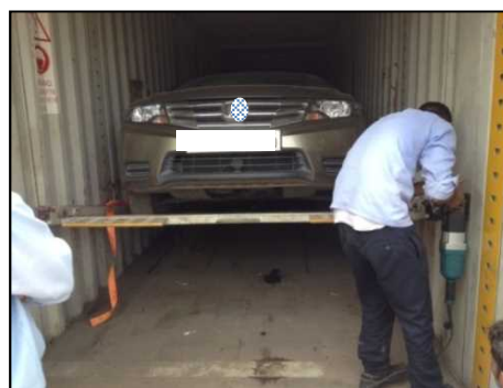
(インパクトドライバーを使ってラックを上昇させているところ)
