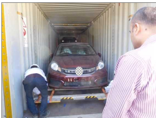
2 台目車両のラッシングベルトを外す
