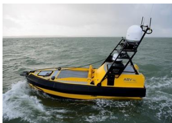
図 16 英国 ASV 社製造の海洋調査等向けの小型無人ボート
