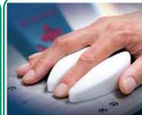
中赤外レーザーを用いた手のひらサイズの非侵襲血糖値センサー
