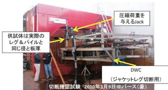
(e) DWC気中載荷切断試験
