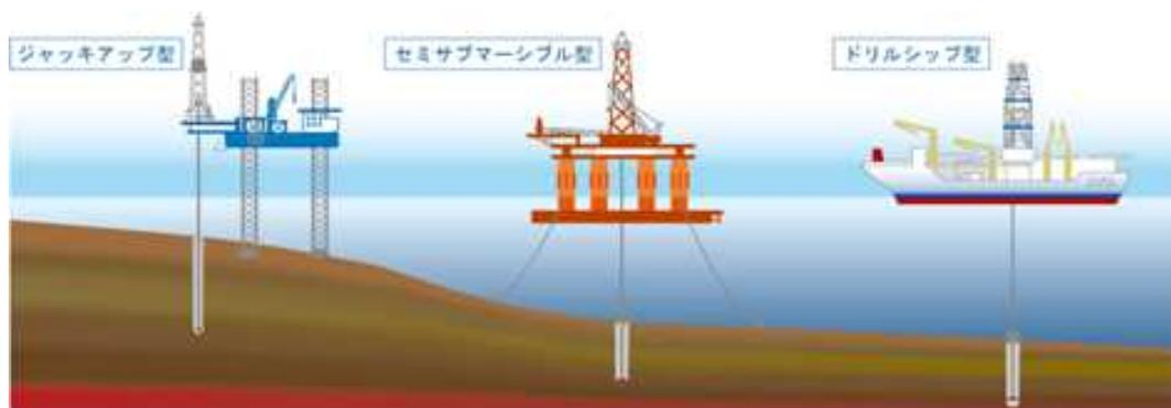
図 2.2.5 掘削リグの種類
