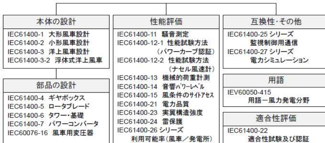
図 2.4.1 IEC の風力発電システムの規格体系 (IEC61400 シリーズ)
