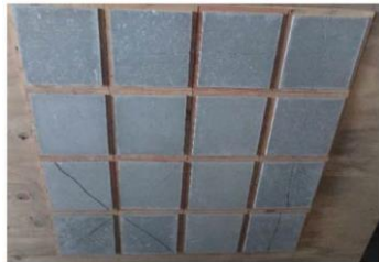
テストピースの例 0.1~1.0mm幅
