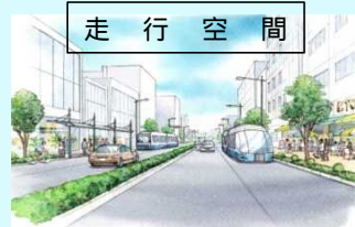
歩道側を基本に、定時性や快適性を確保できる専用・優先レーン
