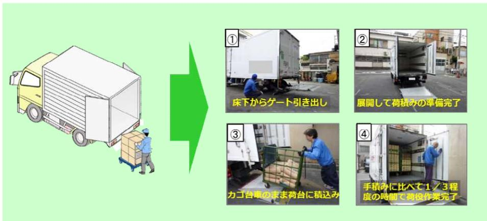
※ テールゲートリフターとは、トラックの荷台後部(テールゲート)に取り付けられた荷物積み降ろし用の昇降装置。荷物を載せて床面と地面の間を行き来するため、荷役機器を使用せず、ドライバー1人で比較的重い荷物の積み降ろしが可能
