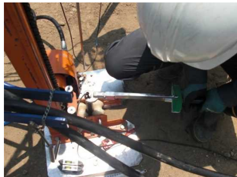
写真 1-3 トルク測定状況 1)
