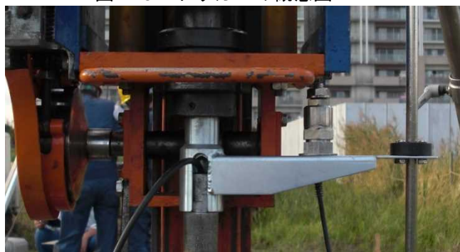
写真 1-1 トリガーの設置状況 1)
