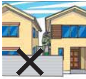
▲ブロック塀が死角をつくり、侵入の足場ともなる
