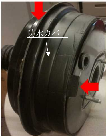
(不適切な防水カバーの取付)
