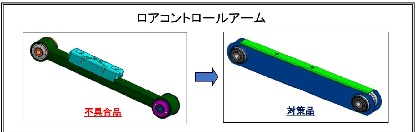
リヤサスペンションのロアコントロールアームの水抜き穴の位置が不適切なため、ロアコントロールアーム内に浸入した雨水が適切に排出されないものがある。そのため、当該アーム内に腐食が生じ、最悪の場合、ロアコントロールアームが折損するおそれがある。
