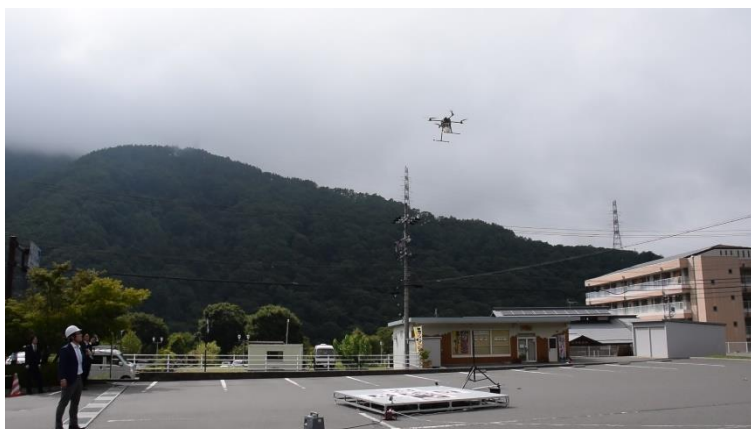
図 3.4 第三者侵入検知時のドローンの飛行制御 （人がドローンポートから離れ着陸を再開するシーン）
