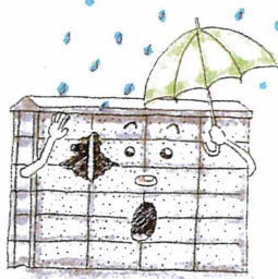
②雨水等の浸入による鉄筋のさび
