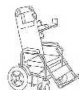
チンコントロール型 あごを利用して操作する。
