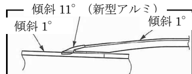
図 段差を少なくした緩傾斜のコム。よりスムーズな乗り降りをサポートするため、コムのすくい角を従来の34度を11度にして段差を軽減した
