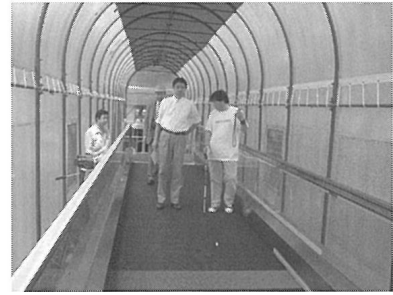
写真 4 傾斜型動く歩道のメーカーでの検証風景
