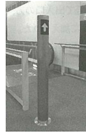
写真3 乗り口を誘導する音声が出る発停ポスト
