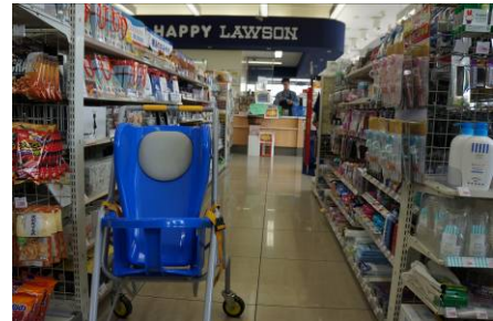
ベビーカー、車イスを考慮した通路幅：ベビーカー、車イス、買物用カート等の利用時でも人とすれ違える1,200mm以上の通路幅
