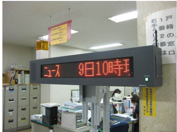
・LED電光表示板（上部に設けられているのは、緊急情報の表示と連動した回転灯とニュースや緊急情報を受信するアンテナ）
