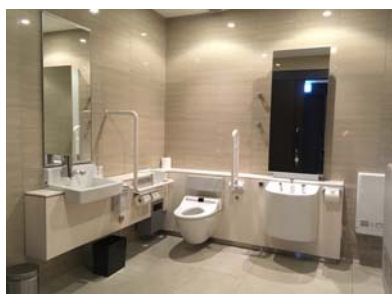
C 多機能便房 車いす使用者の利用に配慮したスペース (約 2.2×3.0m カウンター含まず) に、オストメイト用設備、大型ベッド、乳幼児用いす、乳幼児用おむつ交換台、着替え台を備えている。
