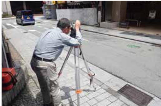
トランシットによる測定状況
