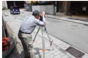
[写真02] トランシットによる測定状況
