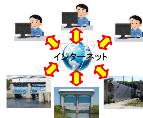
(研究例) 水門等の開閉状況の一元監視
