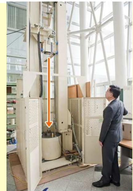
上から矢印の方向に機械が衝撃を加えます。加速式衝撃圧縮試験装置は、時速約70kmまでの負荷速度で圧縮試験が可能です。
