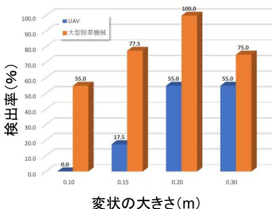
除草機械・UAV搭載レーザー測量画像を用いた堤防点検経験者による机上判読結果 (平成29年度国総研調査成果)
