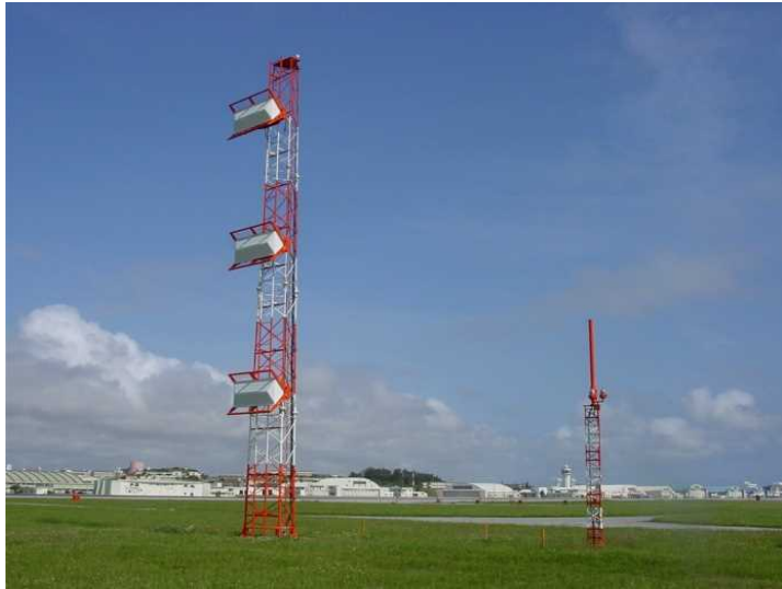
ILS グライドスロープアンテナとターミナルDMEアンテナ
