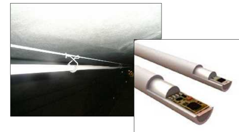
半導体を利用した火点検出装置**
