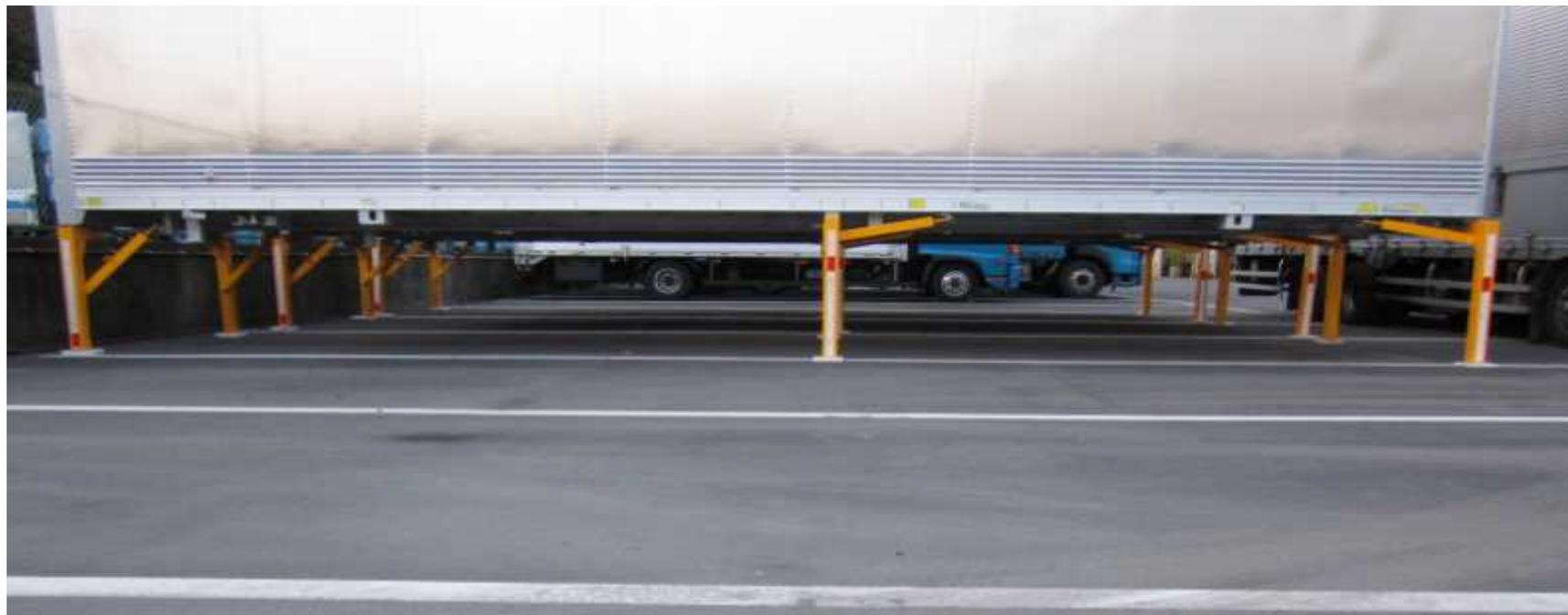
コンテナを設置する際に支持脚下部のプレート（1枚2.5cm）を前後で2枚以上の差（5cm）が生じた場合、コンテナと車両が傾斜角度の問題で干渉または離脱する可能性が極めて高くなるために、設置場所の変更を行うか、脱着作業を慎重に行う必要がある。
