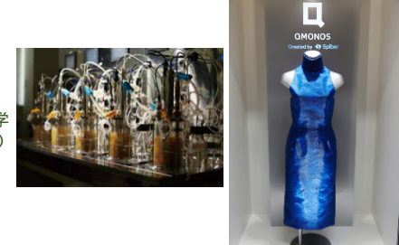
写真左：人工合成クモ糸繊維QMONOST™の製造工程。微生物に合成したクモ糸タンパク質のDNAを導入し、培養して数を増やす。 写真右：人工合成クモ糸繊維QMONOST™が使われた世界で初めてのドレス（2013年5月発表）。（写真提供：Spiber）
