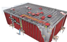
③自動倉庫型 ピッキングシステム
