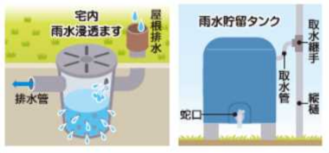
雨水浸透ます・雨水貯留タンクの設置
