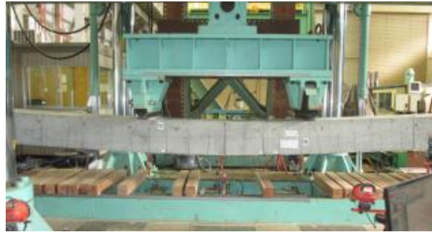
参考 図-1-4 載荷状況の例
